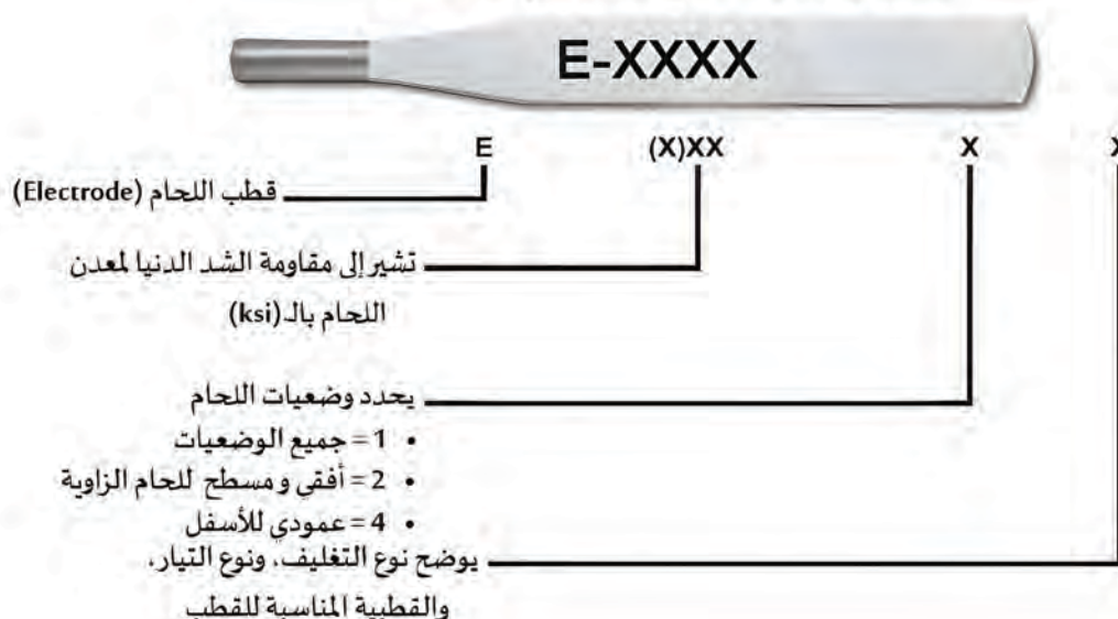
نظام ترميز أقطاب اللحام بالقوس المعدني المغلف SMAW
