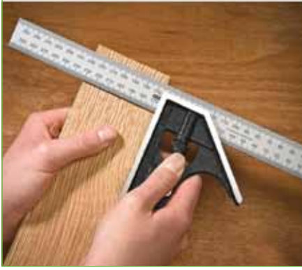
قياس الزاوية 45^\circ
