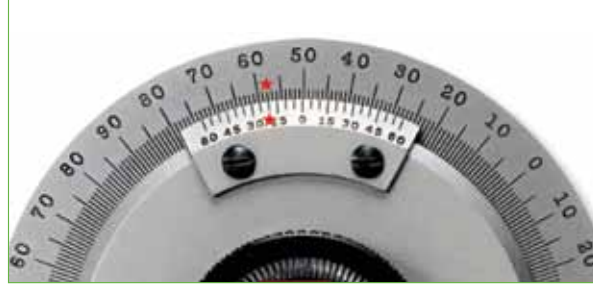
قياس الزاوية باستخدام المنقلة المحورية ذات الورنية
