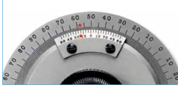
قياس الزاوية باستخدام المنقلة المحورية ذات الورنية
