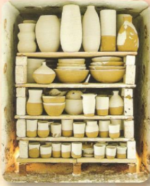
شكل (٣٥) عملية رص الأشكال الخزفية في الفرن.
