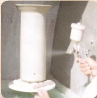
شكل (٣٤) طريقة الطلاء بالرَّش.
