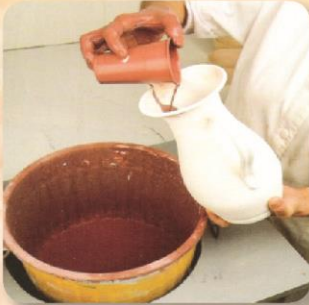
شكل (٣٣) طريقة الطلاء بالسكب.
