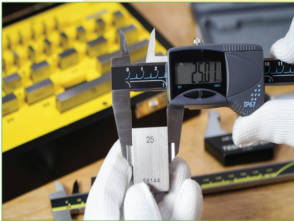
فحص الدقة باستخدام المكعبات المعيارية
