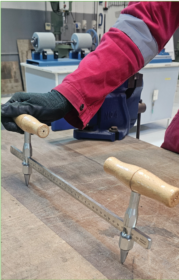
استخدام الفراجار ذو النطاق الواسع لرسم الدوائر بأقطار كبيرة نسبياً
