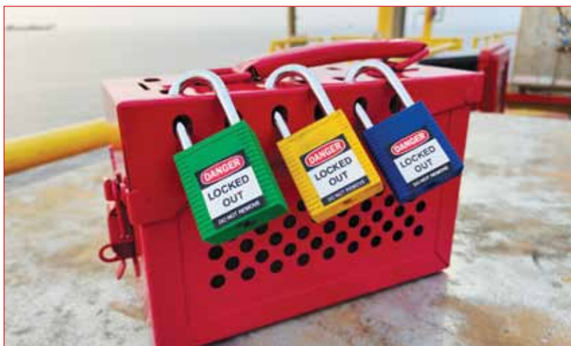
أقفال تأمين مصادر الطاقة الكهربائية والفيزيائية
