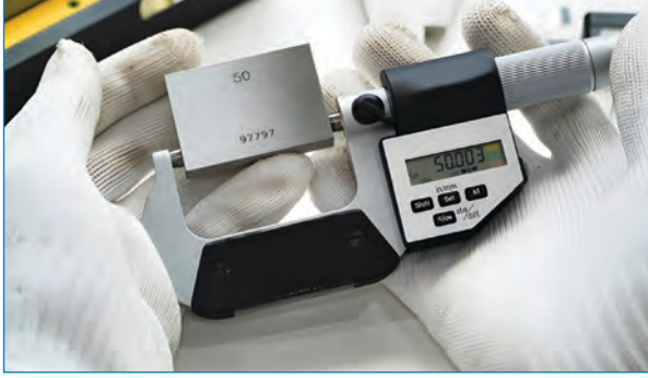
القياس باستخدام الميكروميتر الرقمي
